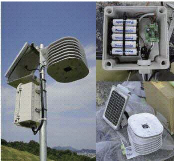
写真1 環境情報自動測定システムの外観
