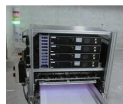
写真 4 LED 照射部 (モジュール 4 基)
