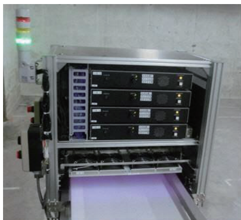
写真2 近赤外光照射装置の基本構成 下段が照射パネル(紫色に発光) 上段4段重ねの黒い箱が電源部
