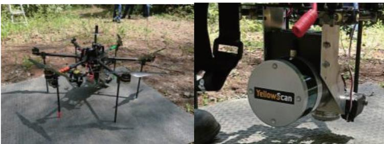
図2 先進モデルのドローンと搭載したレーザースキャナ
