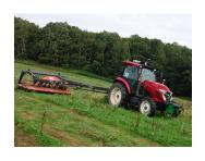
AIで制御されたロボットトラクタで 傾斜地でも牧草を自動で収穫
