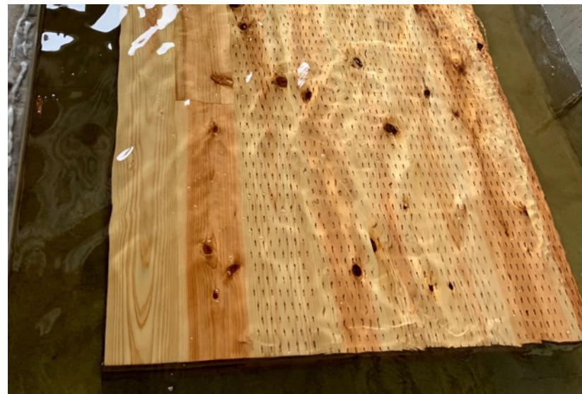
浸漬によるCLTの薬剤処理
