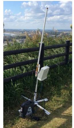
LoRa基地局の通信試験状況
