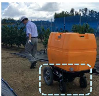
電動車いすをベース車体（耐荷重100kg、左右の重心ズレにも強い）として、GPSと自動走行用のコントローラー、そして、踏圧機構を付加する。
