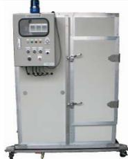
いも表面の病原菌を蒸気により殺菌し、長期貯蔵を可能にする
