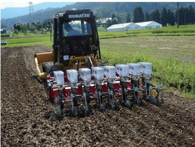
写真3 ICTブルによるソバ小うね立て播種作業
