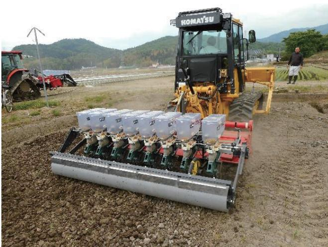
写真2 ICTブルによる水稲乾田直播播種作業
