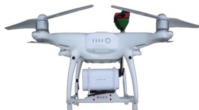
写真1 小型マルチスペクトルカメラ（Parrot Sequoia）を搭載した汎用型ドローン（DJI Phantom 4 pro）
