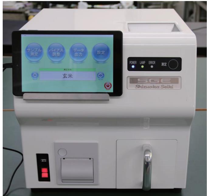
写真 1 最新の近赤外分析計（静岡製機製 SGE）
