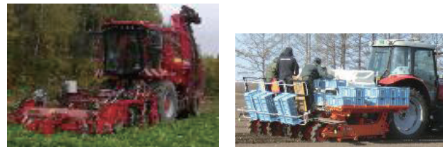
図 1 新技術で支援組織が用いる自走式多畦収穫機（T4-30 図左）と 6 畦移植機（図右）
