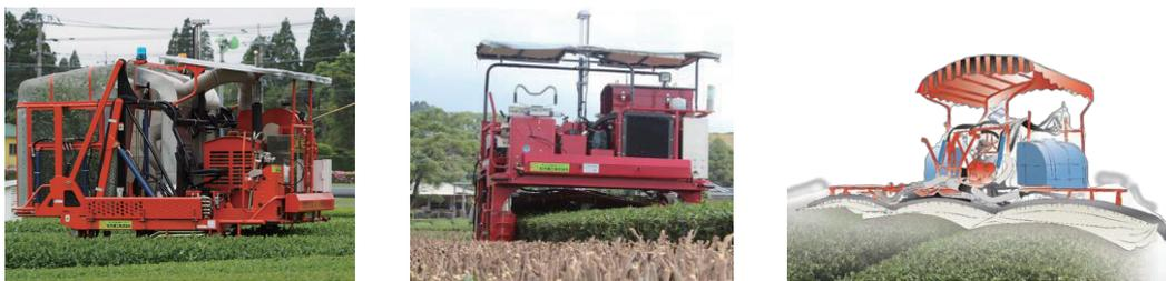
写真1 ロボット茶園管理機（左：摘採機、中：中切機、右：防除機（イメージ））
