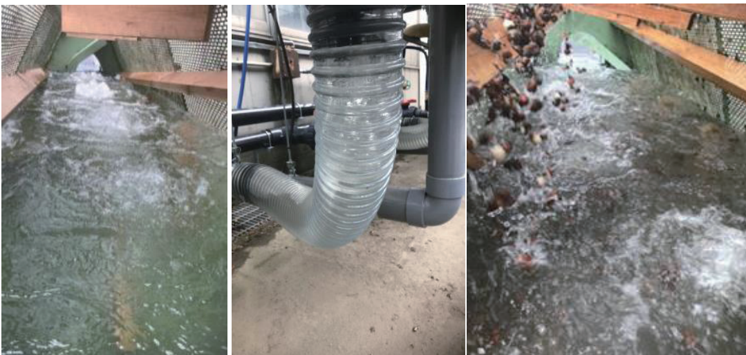
写真4 バブルを発生させ球根を洗浄
