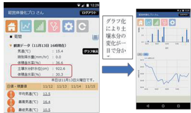
図3 農地環境推定システムの土壌水分等観測データ表示画面
