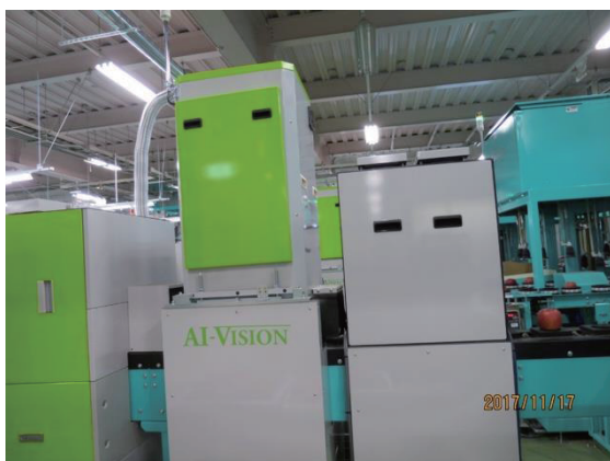
写真1 JAつがる弘前河東選果場に実装されている選果機でのリンゴ由来プロシアニジンの測定
