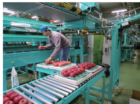
写真1 JAつがる弘前河東選果場に実装されている選果機でのリンゴ由来プロシアニジンの測定
