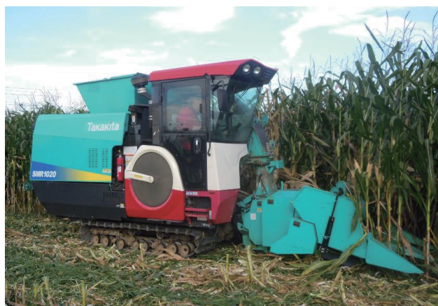
図1 開発したスナツパヘッドを装着した汎用型飼料収穫機
