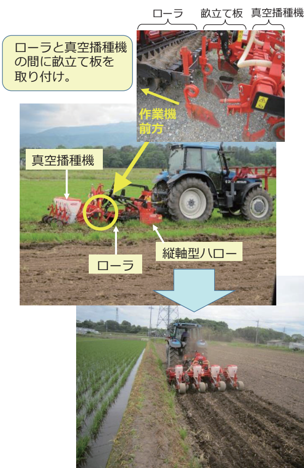
図1 高速耕うん同時畝立て播種機の構成
