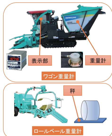
図2 汎用型微細断収穫機と重量測定機能
