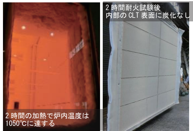
写真3 耐火試験の様子
