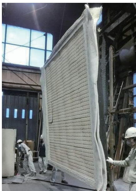
写真 1 2 時間耐火試験後の試験体表面 (外壁屋外側)
