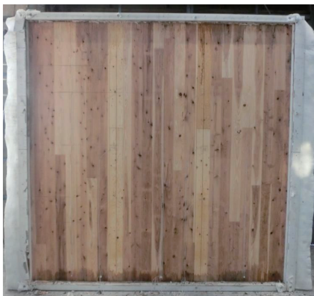
写真 2 試験後に耐火被覆を除去した CLT の表面 (CLT 表面に炭化等は生じていない)
