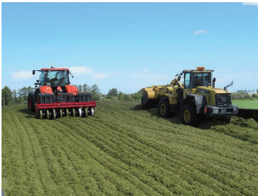
写真1 間口15mのサイロにおける有人車両(黄色)とロボットトラクターによる同時作業(協調)
