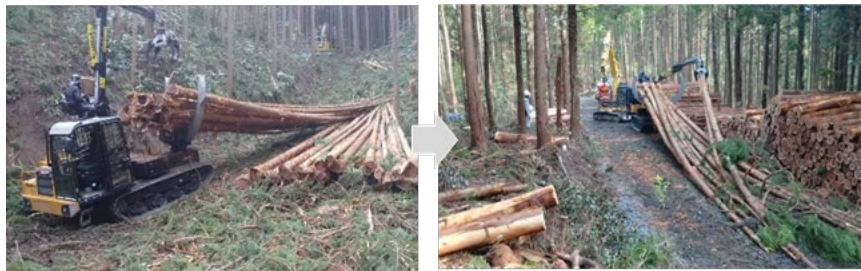
写真4 クラムバンクスキッドによる作業の様子 左：全木材の荷積み 右：全木材の荷下ろし
