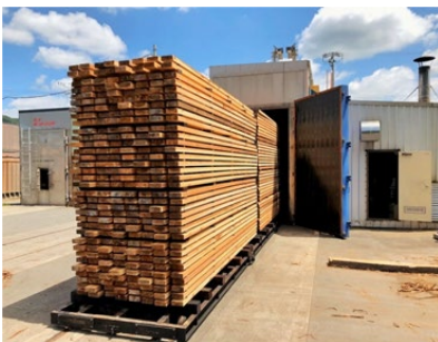
写真 2 スギ間柱材の弱減圧乾燥
