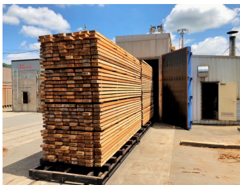
写真1 スギ間柱材の弱減圧乾燥
