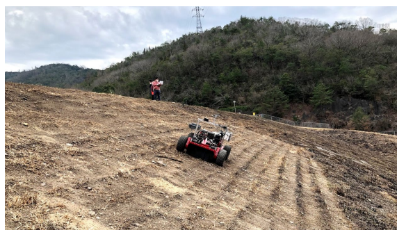
図4 農業用ダム法面走行試験の様子
