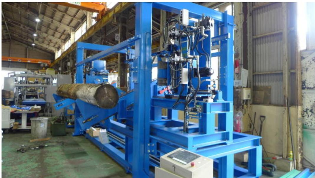
写真1 試作した実大丸太用測定装置
