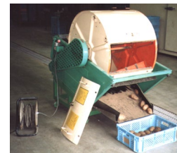
打撲検定機で耐性の評価・選抜
