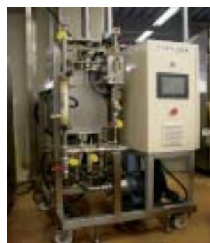
図2 限外濾過膜法によるアポラクトフェリンの製造機
