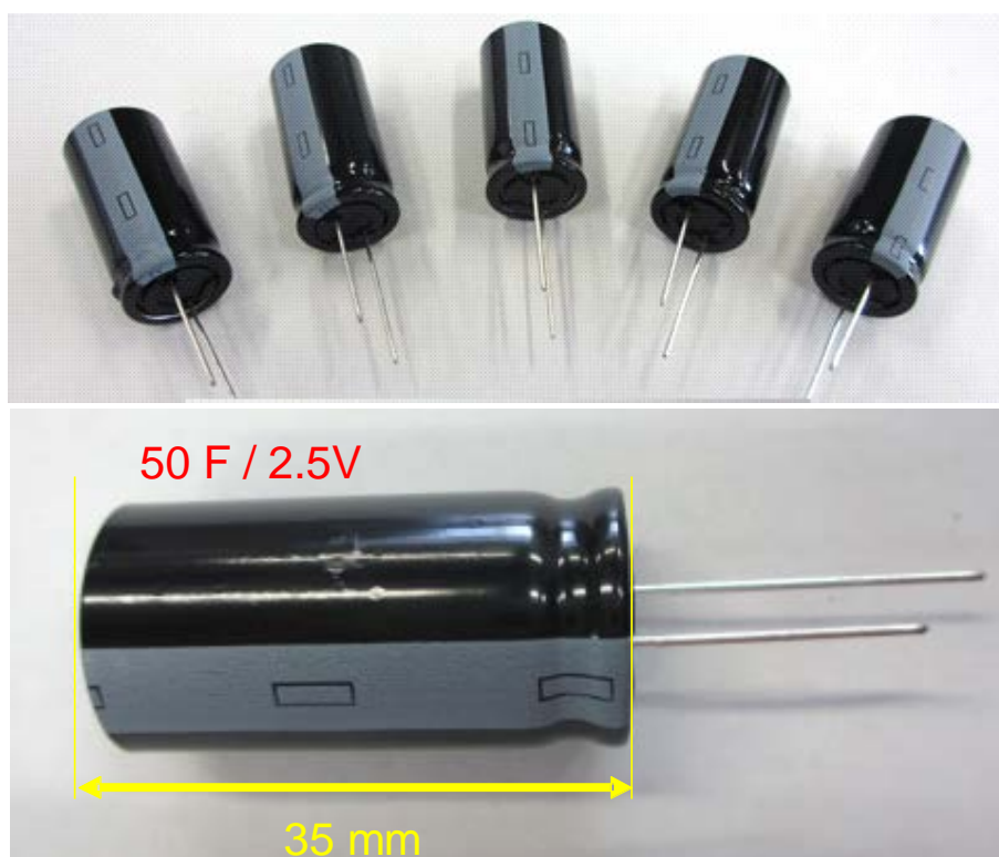
図2 バイオナノカーบอนを電極材として用いて試作した円筒型のキャパシタの写真
