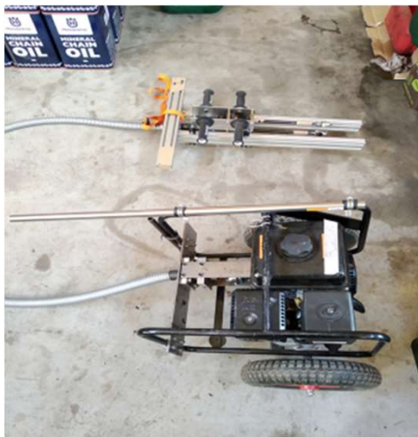
膨張剤施工用の孔をあける 杉間伐ロボット およびロボット用運搬機
