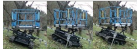
全ての方向で荷台水平制御可能
