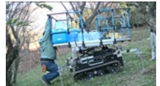
水平制御後も十分な耐荷重性能
