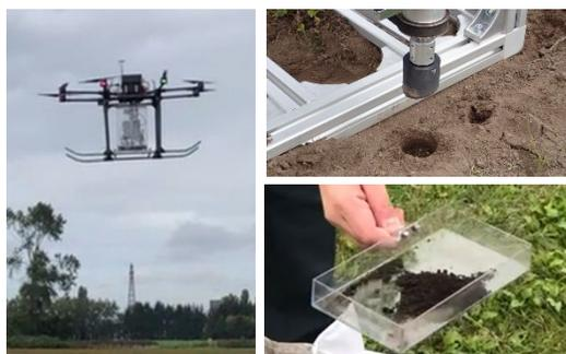
図2 圃場上空を移動するドローンおよび土壌サンプリングの結果
