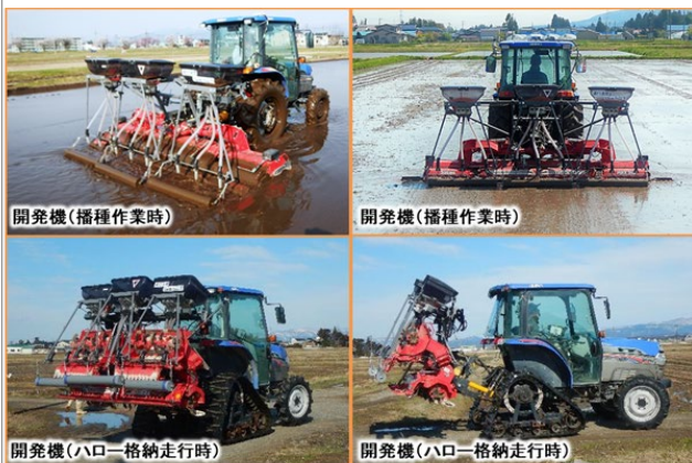
図1 折りたたみ式ハローに対応した大型播種機
