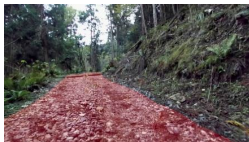
図3 深層学習により画像から路面を自動検出(上図の赤く塗られた部分)
