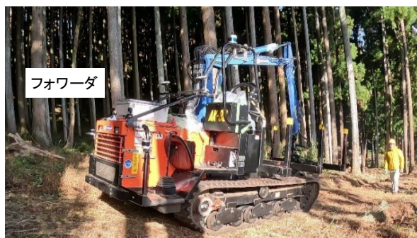
図4 ゴール地点の指示だけで、狭小な作業道を300m以上、人の介入無しで走行
