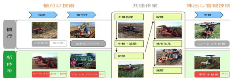
図3 サトウキビの機械化一貫体系と新体系
