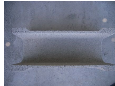
繊維成分配合、軽量・薄肉化ポーラスベッド 幅20cm、深さ20cm
