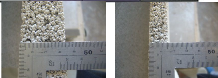
繊維成分配合、軽量・薄肉化ポーラスベッド 壁厚 3.5cm ⇒ 1.5cmまで薄肉化
