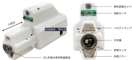
図2 トマト果実品質評価デバイスの外観 図3 自走式ロボットおよびアームシステムとその動作
