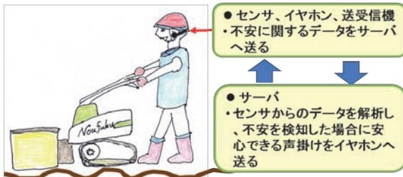
図2 不安検知・安心声掛けシステムの概要
