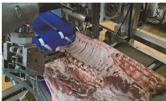
(2) 肋骨の先端にワイヤーをチャックする
