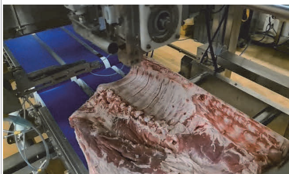
(1) ロボットはワイヤーを肋骨の先端まで移動
