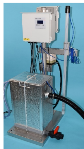
写真1 発電細菌を利用した BOD 監視システム（山形東亜 DKK 株式会社提供）
