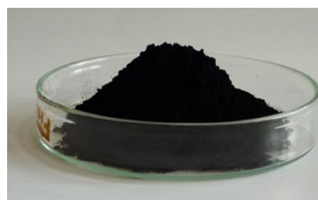
写真2 蓄電量を増やす電極材料のナノ素材（ナノサミット株式会社提供）
