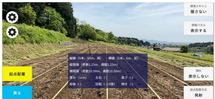
写真2 Agri-ARを利用してスマホ等の画面上で、圃場の画像に農作業用のガイド直線を重ねて表示、線の間隔なども自在に指定できます
