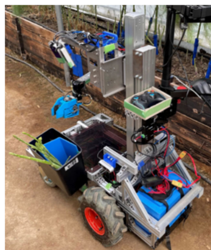
写真4：柵板式高畝栽培用の自動収穫ロボット ＝ inaho 株式会社提供
