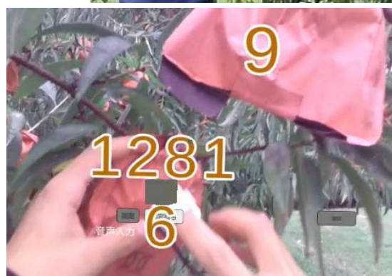
樹上の果実硬度を測定すると（写真上）、作業者のスマートグラス画面上に硬度を示す共鳴周波数「1281」と収穫適期までの日数「6」が AR 表示されます（写真下）
