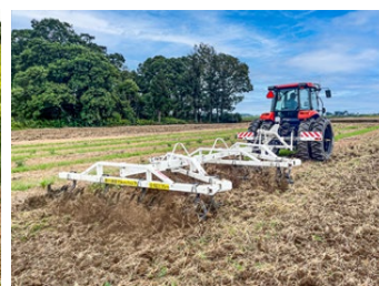
写真2：リボンローラー（左）とランドハロー（右）
