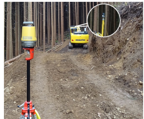
写真1 トータルステーションによるショベル位置の計測
