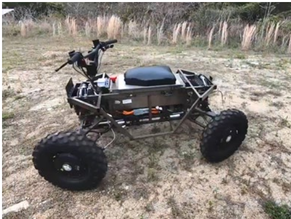
図1 電動運搬車両（リモコンによる走行が可能）
