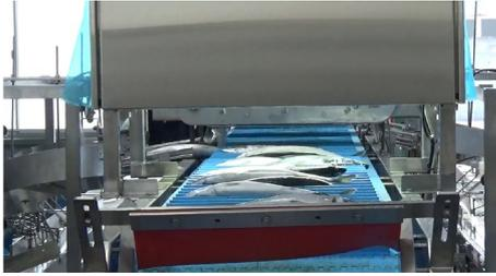
写真1 画像センシング装置で向き判定後、振分装置に向かうさば類
