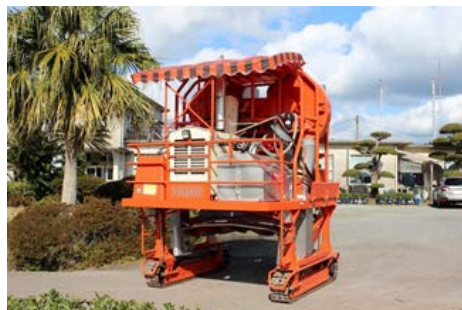
写真3 サイクロン式吸引洗浄機（左）及びサイクロン式茶園クリーナー（右）
