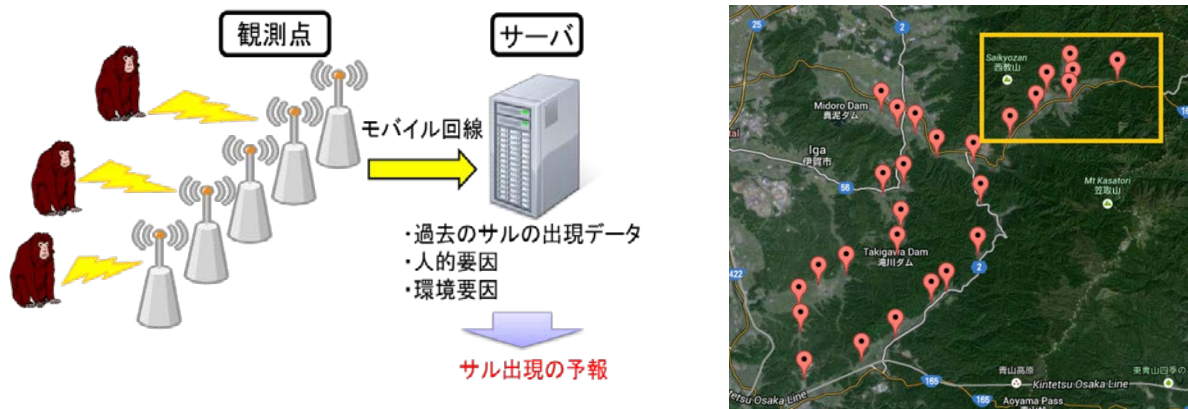
図4 接近検知システムの仕組みと、Web上での位置情報の表示画面
