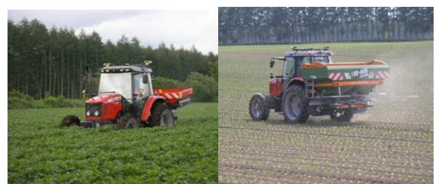
(センサーベース可変追肥) (マップベース可変施肥) 写真8. 生育センサによる可変施肥作業
