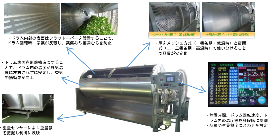
図5 香気発揚を安定化させるドラム式萎凋機
