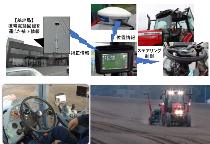
写真7. RTK-GNSS 自動操舵のしくみ（上）と自動操舵作業（左下、右下）の様子
