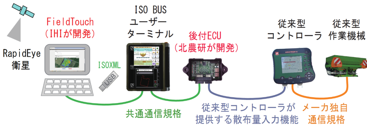
図4. 後付型ECUと衛星画像を利用した可変施肥技術
