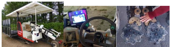
写真6. 改良したキャベツ収穫機（左）とバックモニター（中）、姿勢制御機構（右）
