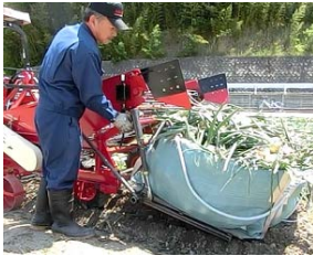
油圧を解除して荷台を後方に傾斜させる
