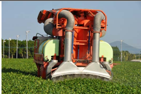
写真3 サイクロン式吸引洗浄機（左）及びサイクロン式茶園クリーナー（右）
