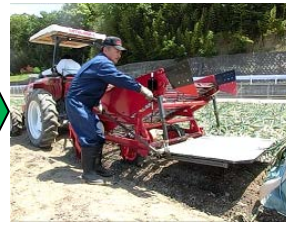
手動式レバーで荷台を上げ油圧をロックする
